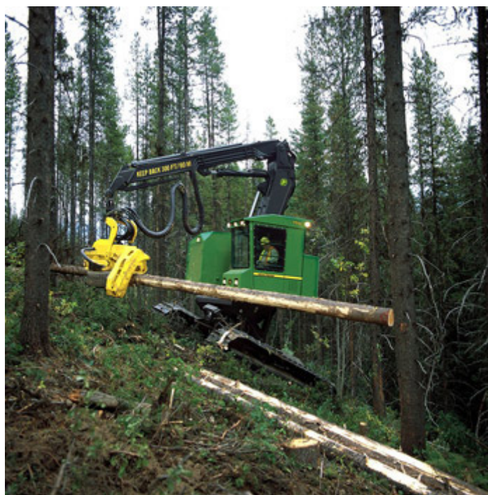
Рисунок 2. Харвестер на базе экскаватора John Deere 759G (Фотография: John Deere)
