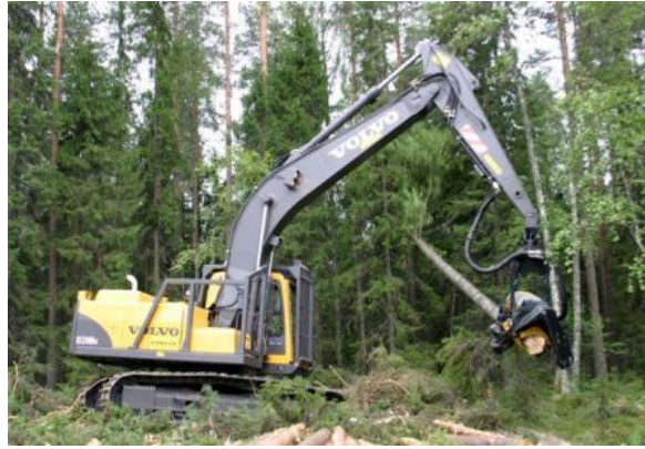
Рисунок 6. Харвестер на базе экскаватора Volvo EC210BF (Фотография: А. Селивёрстов)
