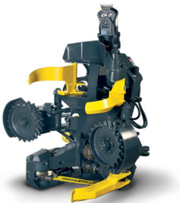
Рисунок 8. Харвестерная головка (Фотография: Ponsse Oyj)
