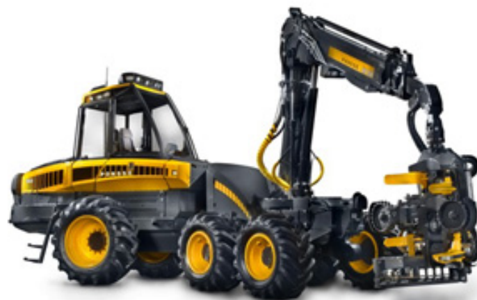
Рисунок 1. Одномодульный харвестер Ponsse Ergo (Фотография: Ponsse Oyj)
