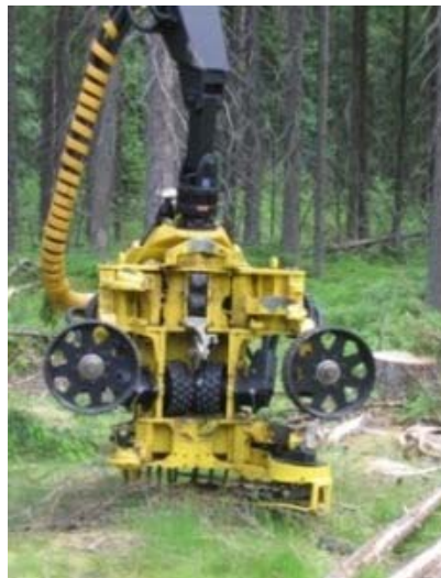
Рисунок 7. Харвестерная головка John Deere 758 HD (Фотография: А. Селивёрстов)
